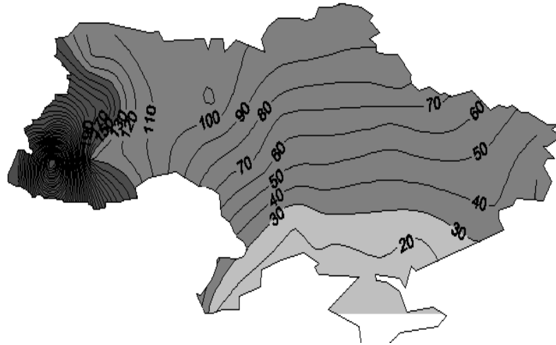
Рисунок 3.1 – Просторовий розподіл норм річного кліматичного стоку на території України за даними до 1989 р. [59]
