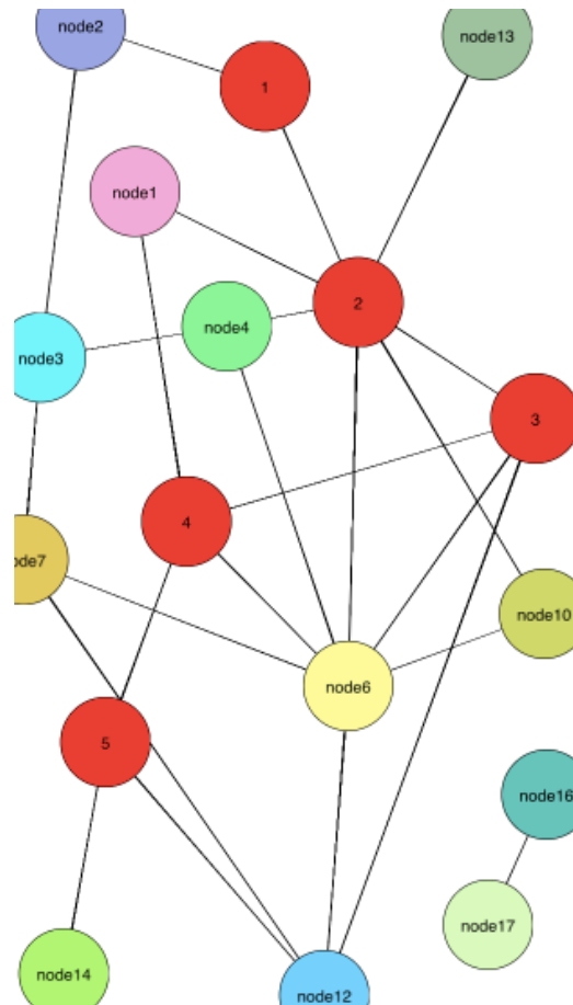
Рисунок 4.13 – Пошук альтернативного найкоротшого шляху від вершини node6 до node9
