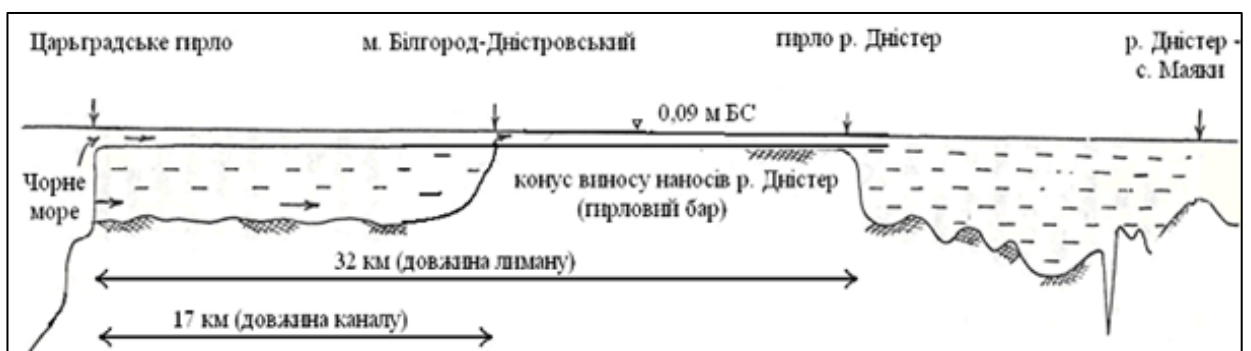
Рис. 1.4 – Схема повздовжнього перерізу Дністровського лиману та гирлової частини р. Дністер (до с. Маяки) [3]
