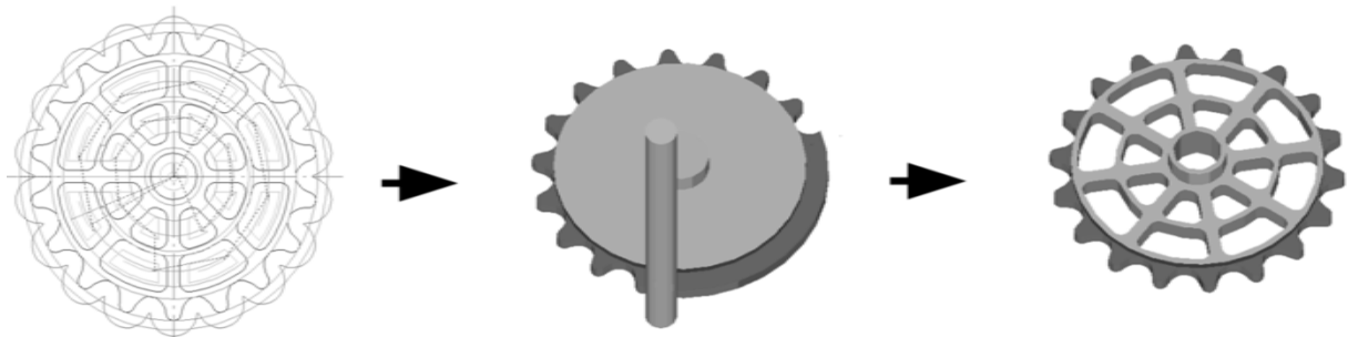
Рисунок 2.8 – Проектування траєкторії руху та моделювання обробки
