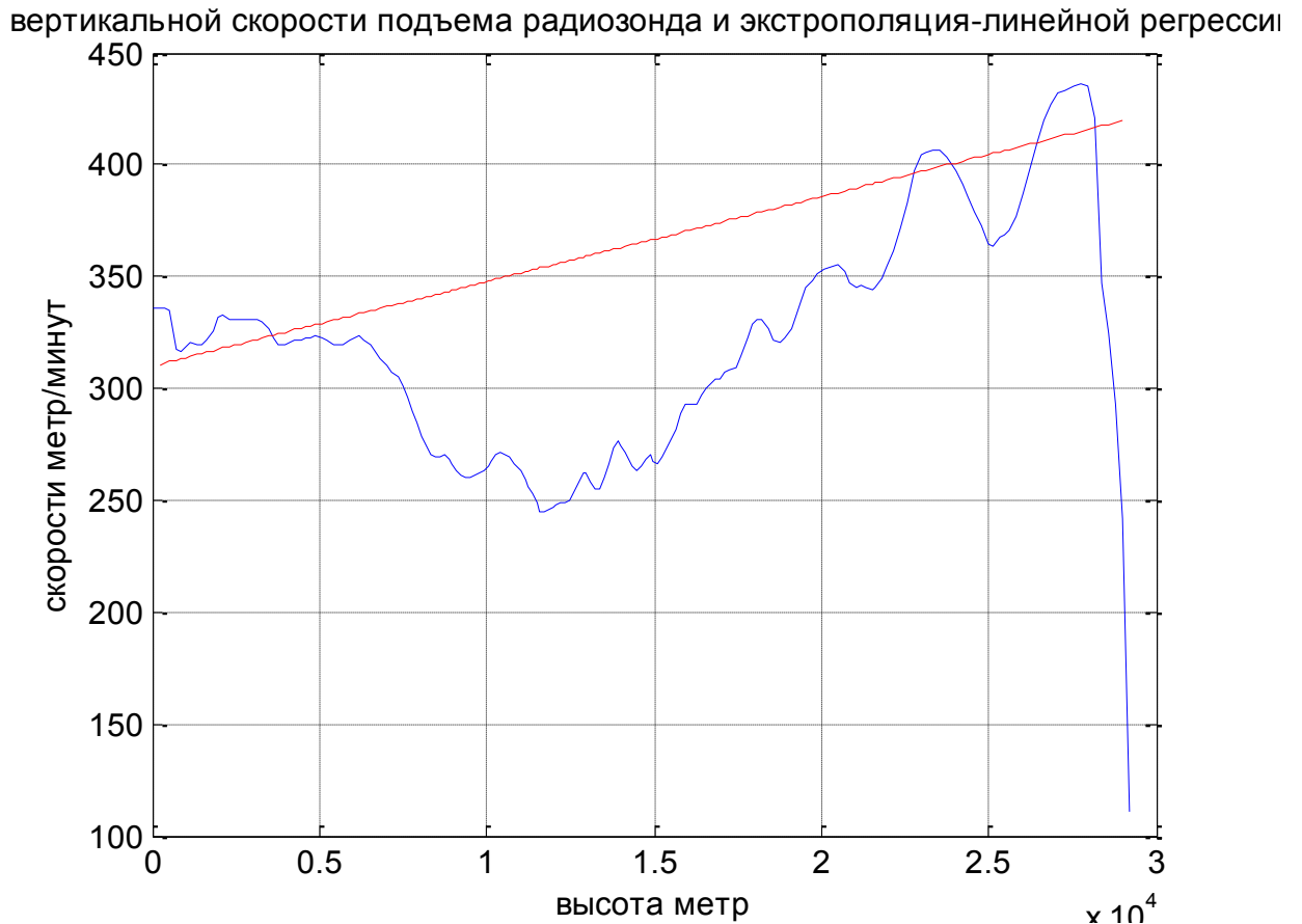
Рисунок 6 – Вертикальна швидкість підйому радіозонду та екстраполяція лінійної регресії
