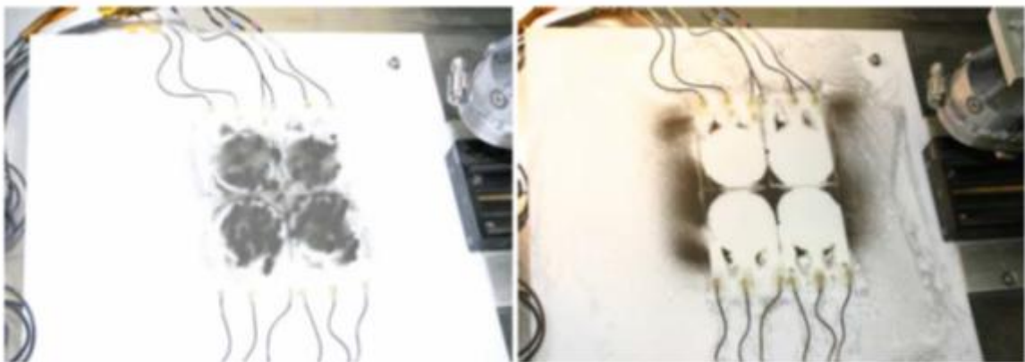
Рис. 3.1 - Розміщення електродів в модулі створення електрофоретичного руху
