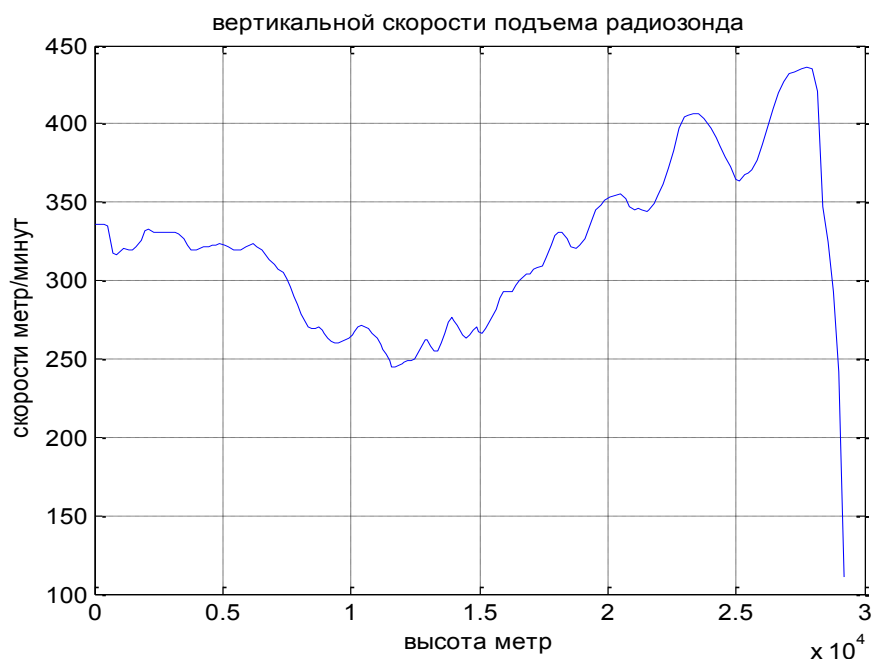
Рис. 3.3. Вертикальної швидкості підйому радіозонда.
