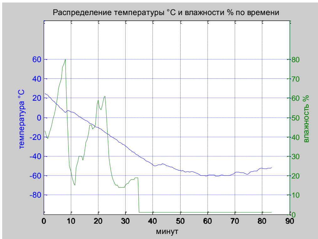
Рис.10. Розподіл температури й відносної вологості зондування атмосфери за часом польоту.
