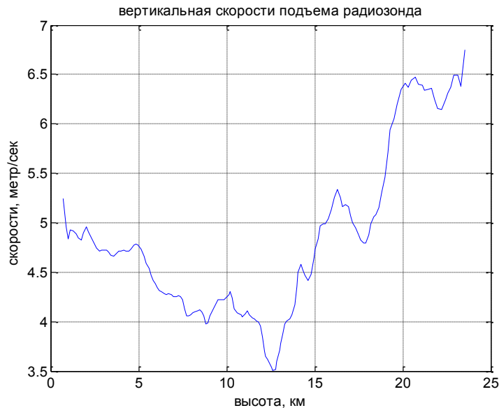
Рис.4. Вертикальна швидкість підйому радіозонда метр/сек
