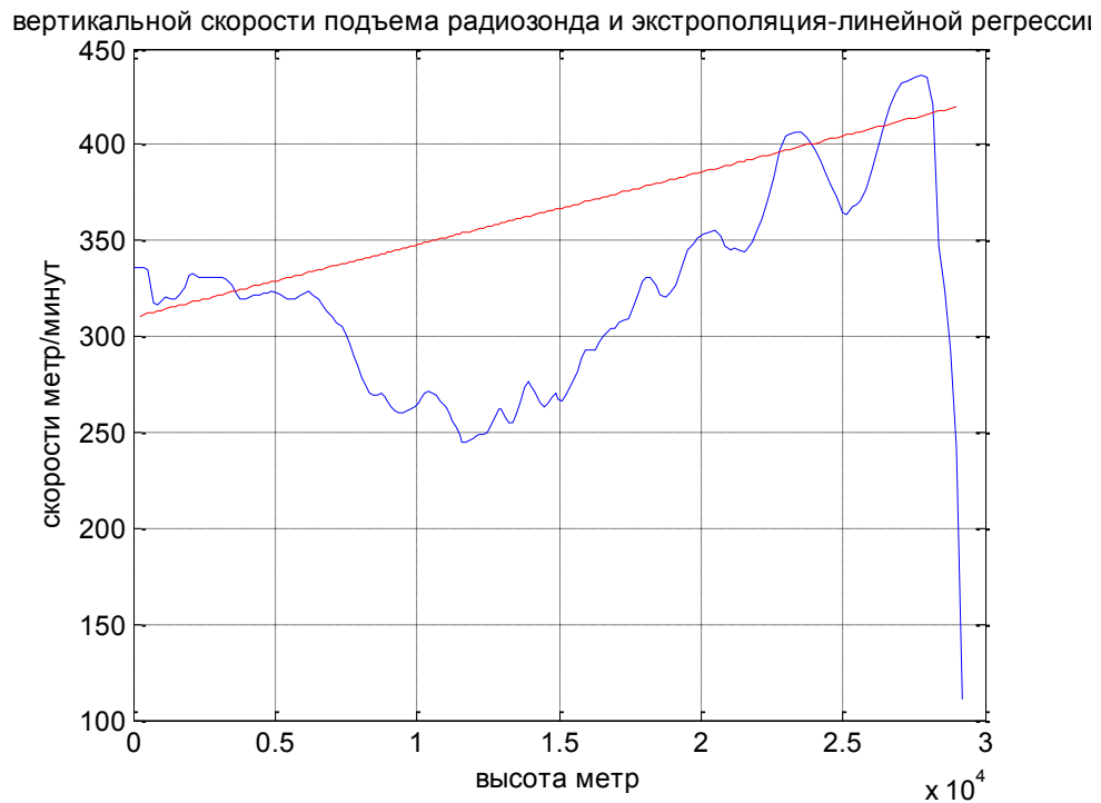
Рис. 3.4. вертикальної швидкості підйому радіозонда й екстраполяція - лінійної регресії.
