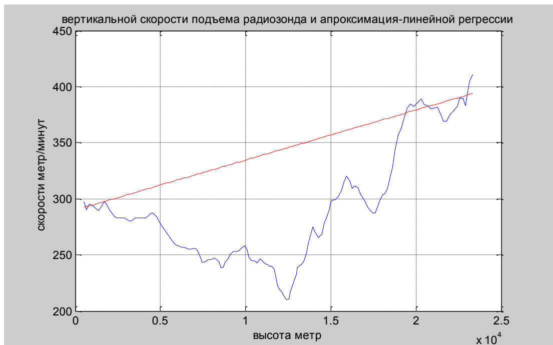
Рис.5. Вертикальна швидкість підйому радіозонда й апроксимація - лінійної регресії
