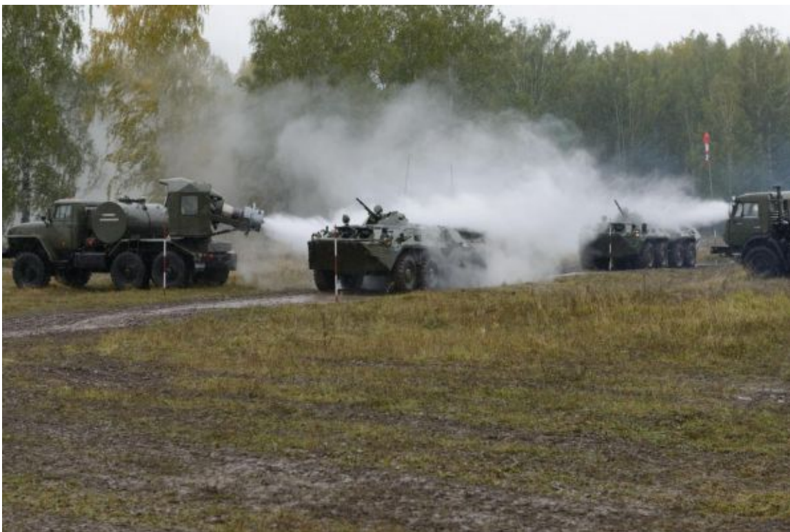
Рис.1.3 Дезактивація за допомогою струменя води
