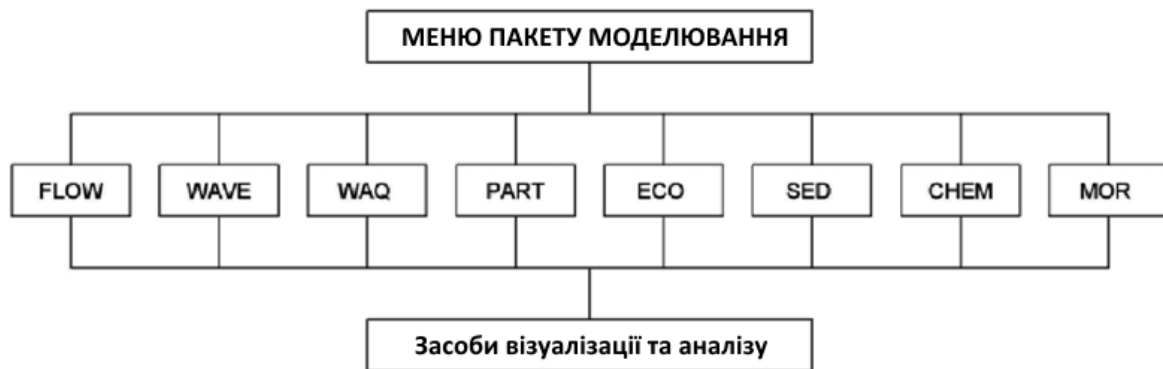
Рисунок 3.1 – Системна архітектура пакету програм Delft3D: FLOW – гідротермодинамічний модуль; WAVE – модуль трансформації хвиль (на основі спектральної хвильової моделі SWAN); WAQ – модуль для моделювання якості вод; PART – модуль розрахунку трасування домішок; ECO – екологічний модуль; SED та MOR – модулі для розрахунку транспорту наносів та деформацій дна; CHEM – біогеохімічний модуль
