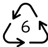
Рис. 1.7 - Маркування полістирол (ПС) або PS.
