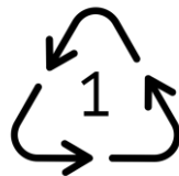
Рисунок 1.3 - Маркування поліетілентерфталат (ПЕТ) або PET(E).
