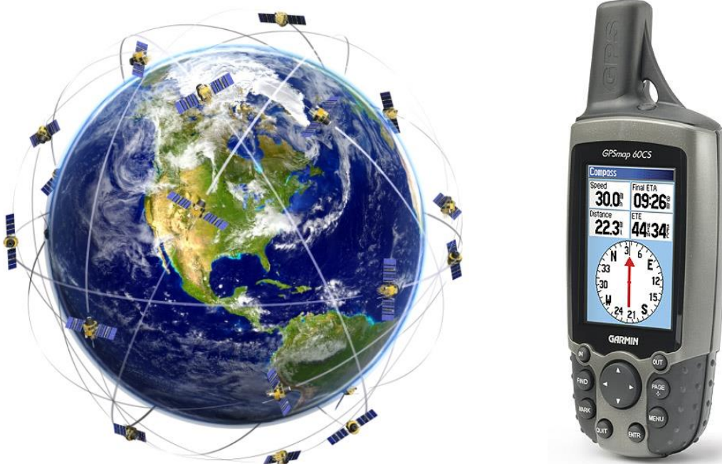
Рисунок 4.2 – Орбітальне угруповання супутників системи GPS і цивільний GPS навігатор «GPSmap 60CX» (фірма «Garmin»)
