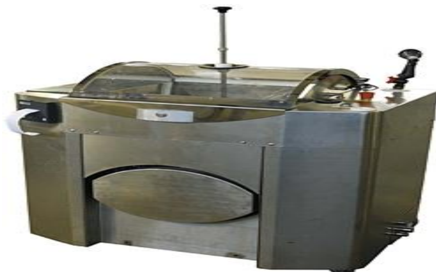
Рис. 2.7 – Установка для знезараження медичних відходів Steriflash
