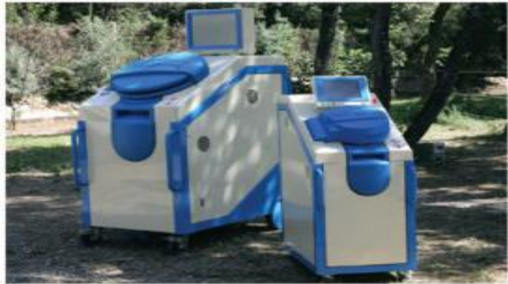
Рис. 2.1 – Апарат Sterigerms для пресування відходів
