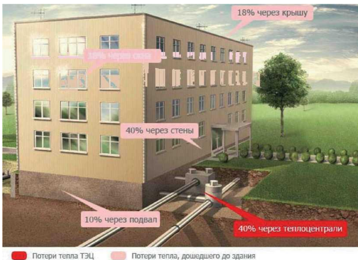
Рисунок 2.1 - Втрати теплової енергії в будинку та магістралях
