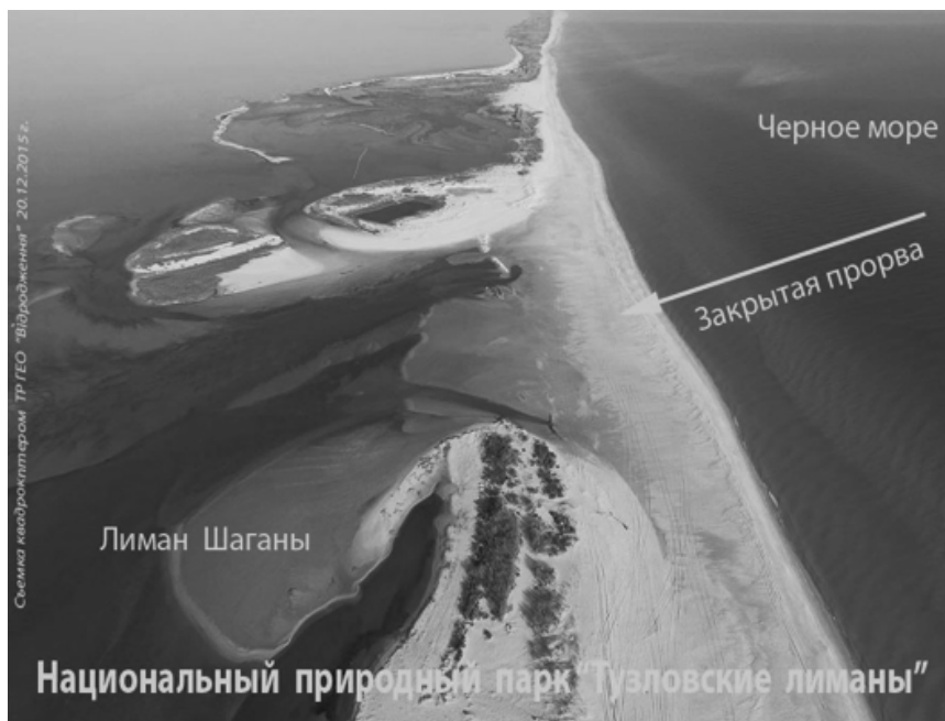
Рисунок 7.5 - Таж ділянка коси (24 км) після закриття «дикої прірви» і результати занесення піском прилеглої акваторії лиману Шагани
