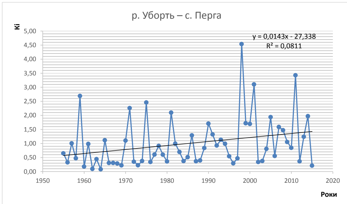
Рис. А18 - Хронологічний графік ходу мінімальних витрат води зимової межені р. Уборть – с. Перга(у модульних коефіцієнтів)
