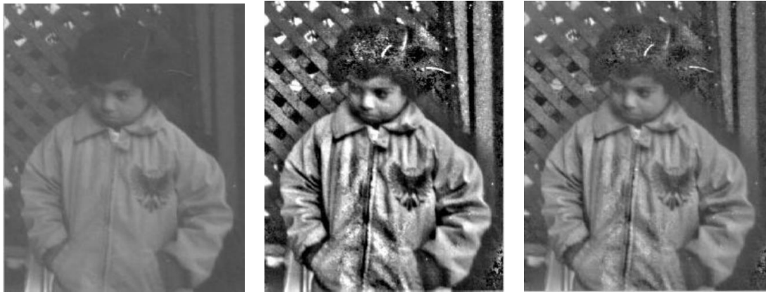
Рисунок 3.17 – Результати обробки зображення, отримані з використанням формули (5.5): а) вихідне зображення; б) результуюче зображення при k = 0,7, m = 35 ; в) при k = 0,3, m = 35
