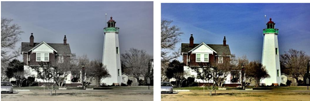
Рисунок 4.16 – Приклади застосування алгоритму Multi-Scale Retinex для значень Q=7, 480, 4\ 800 (ліворуч) плюс лінійне розтягання контрасту (праворуч)
