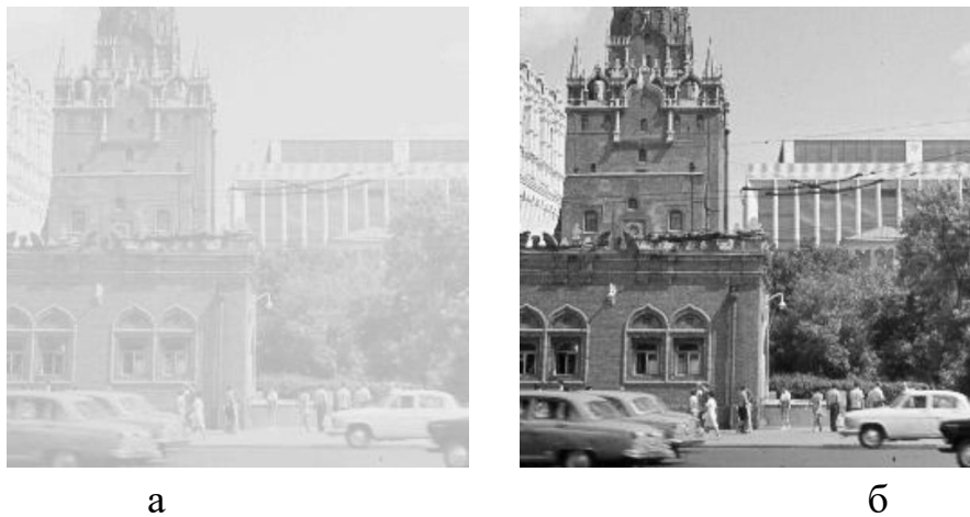
Рисунок 3.7 – Світле зображення (а) з діапазоном яскравості x_{min} = 180 , x_{max} = 240 перетвориться за допомогою лінійного розтягання контрасту (б)
