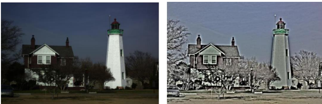
Рисунок 4.15 – Приклад застосування алгоритму Single-Scale Retinex при \sigma = 18 : вихідне зображення (ліворуч), результат (праворуч)
