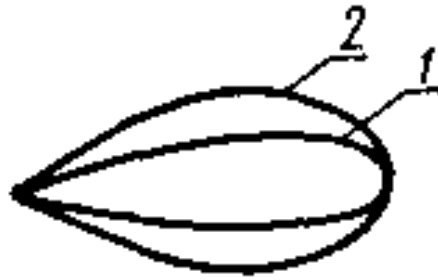
Рис. 2.9 – Голчасті діаграми спрямованості двох антен
