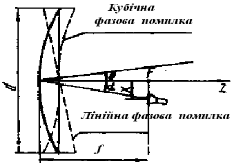
Рис. 6.6 – Принцип управління положенням ДС дзеркальної антени
