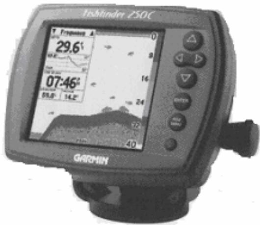
Рис. 2.7 – Електронний ехолот «Fishfinder-250» (фірма «Garmin»)
