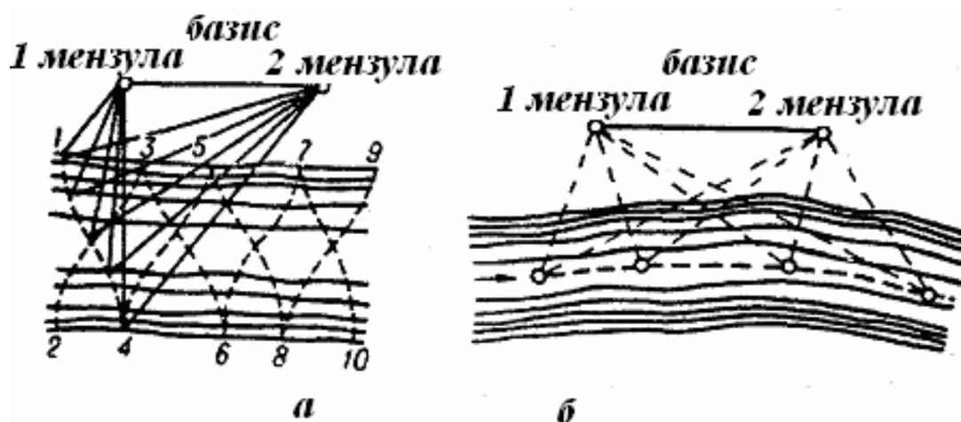
Рис. 2.4 – Проміри: а) косими галсами; б) по повздовжніх профілях
