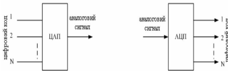
Рис. 2.7 – Представлення в загальному вигляді цифро-аналогового і аналого-цифрового перетворювачів.
