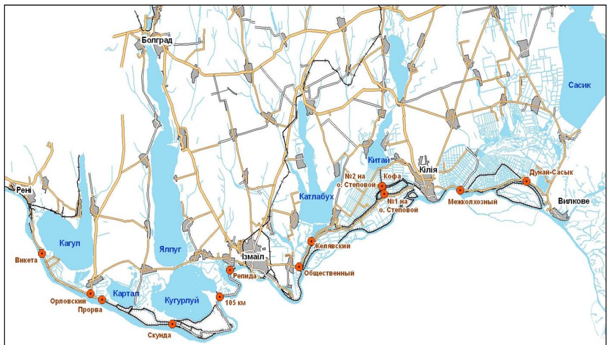
Рисунок 2.1 - Схема розташування шлюзів-регуляторів на Придунайських водосховищах
