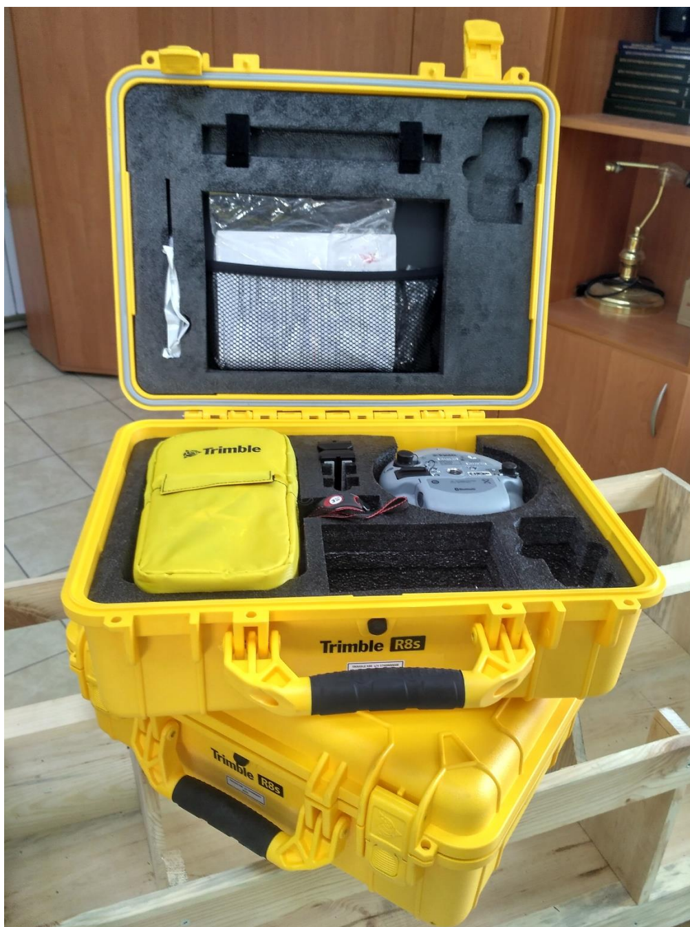
Рисунок 4.7. Комплект спутникових прийомників Trimble R8s.
