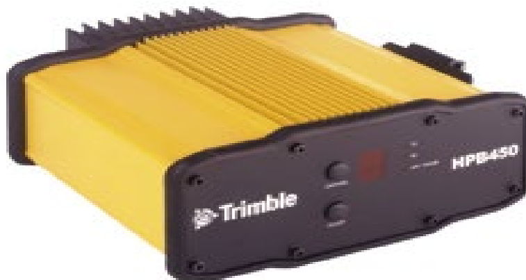
Рис.3.13 - Комплект радіомодема HPB450 з зовнішнім акумулятором.
