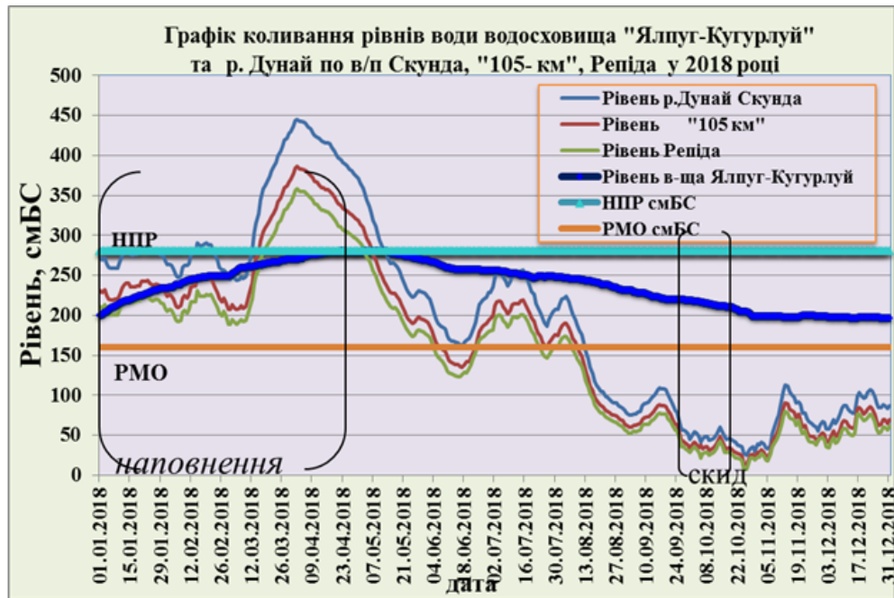
Рисунок 6.24 - Графік коливання рівнів води по водосховищу Ялпуг – Кугурлуй та шлюзів регуляторів у 2018 році [32]
