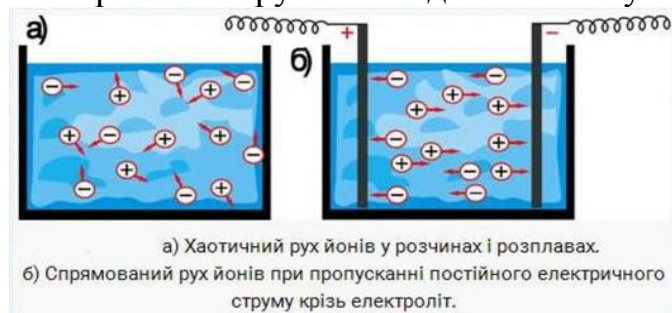
Рис. 1. 24 – Доказ електролітичної провідності
