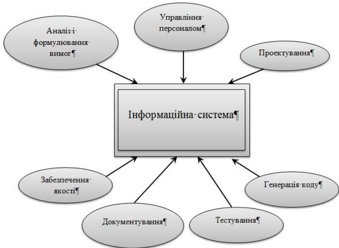
Рисунок 3.1 – Схема використання CASE-засобів
