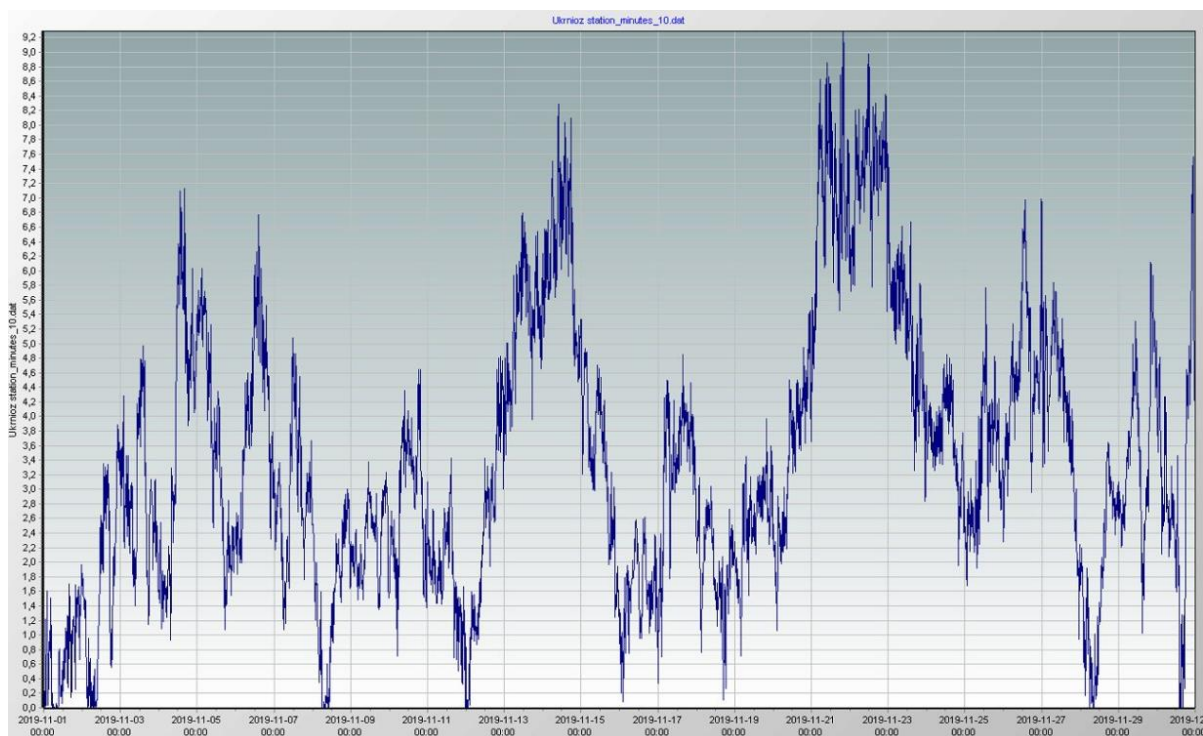
Рис. 3.14. – Графік вимірюваних значень швидкості приладом R.M Young 03002 за кожну секунду спостережень. Листопад
