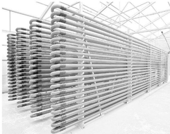
Рисунок 3.5-Культиватор закритого типу для культивування мікрводоростей
