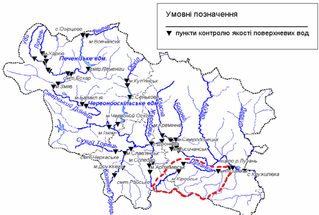
Рис. 1.3 - Схема розташування створів спостережень за хімічним складом води в басейні р. Сіверський Донець
