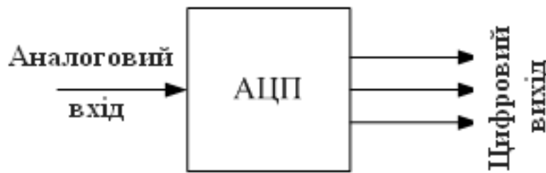
Рисунок 4.7 – Представлення в загальному вигляді аналого-цифрового перетворювача
