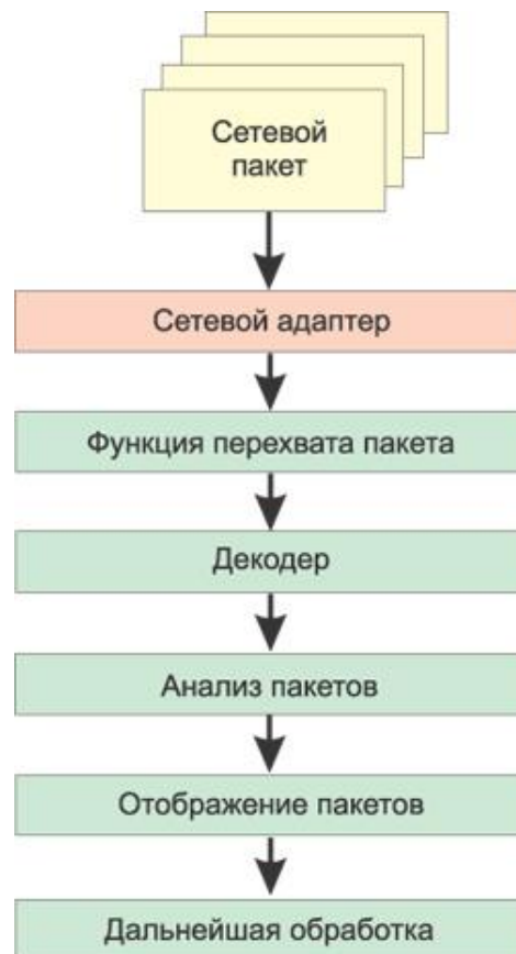
Рисунок 2.1 – Схема роботи сніфера
