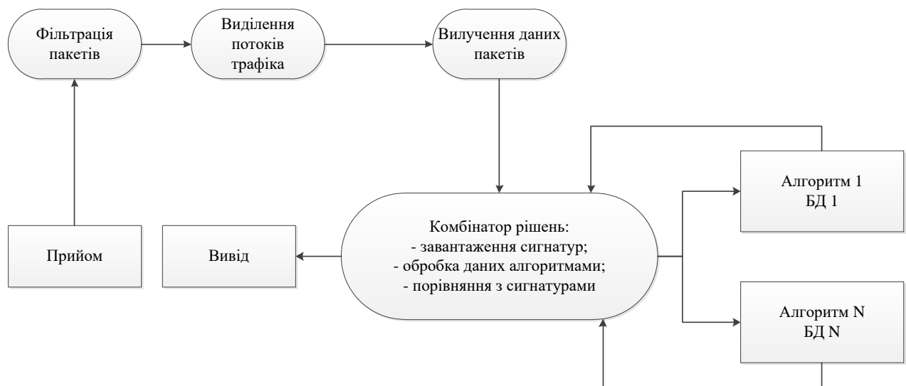
Рисунок 4.1 – Аналіз пакетів DPI з використанням комбінатора рішень
