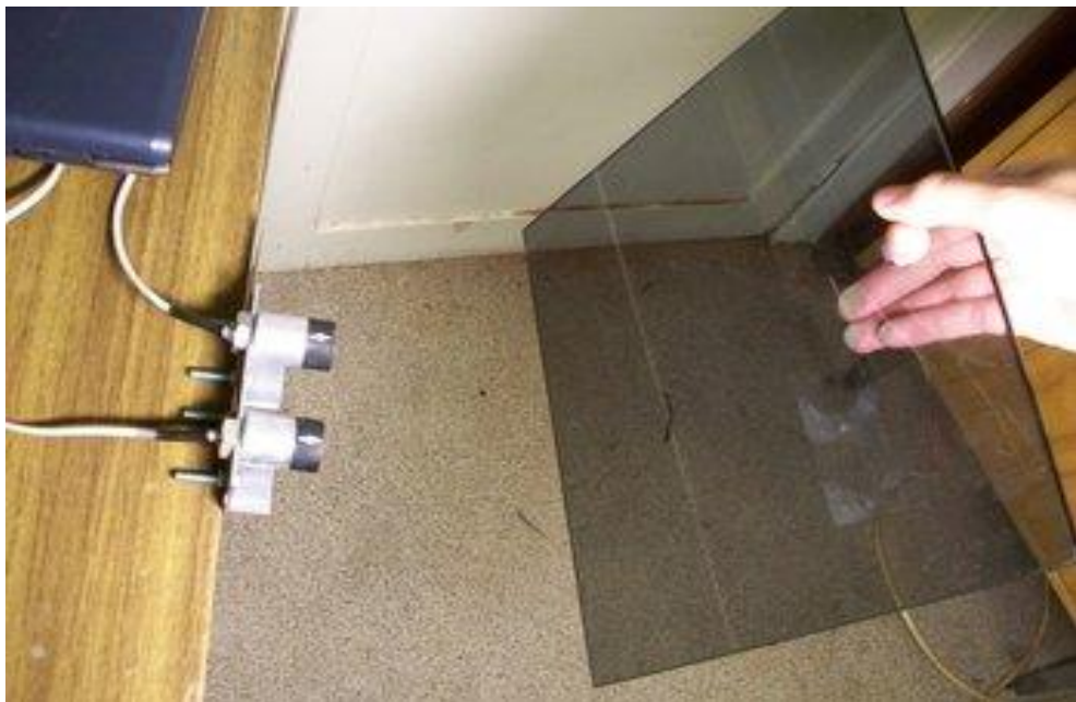
Рисунок 10 – Проведення випробувань УЗ далекоміра
