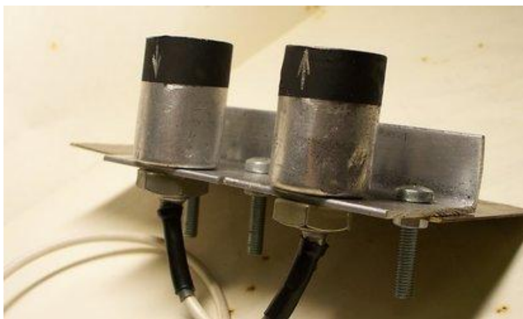
Рисунок 8 – Зовнішній вигляд ультразвукового прийомника-передавача
