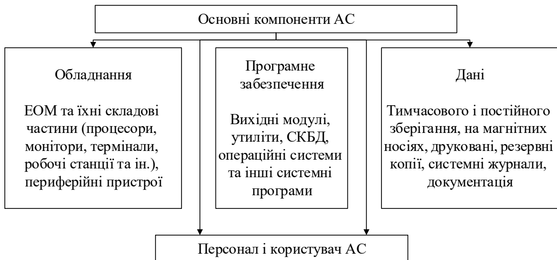
Рисунок 1.6 – Складові автоматизованої системи
