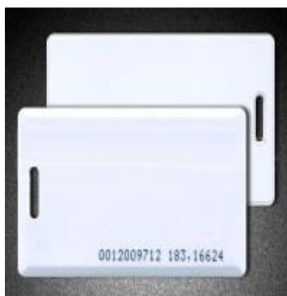
Рисунок 1.6 – Картка Віганда та розшифровка коду
