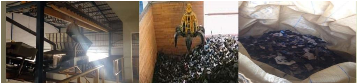
Рис. 3.9 – Подрібнення і розділення компонентів відпрацьованих акумуляторів
