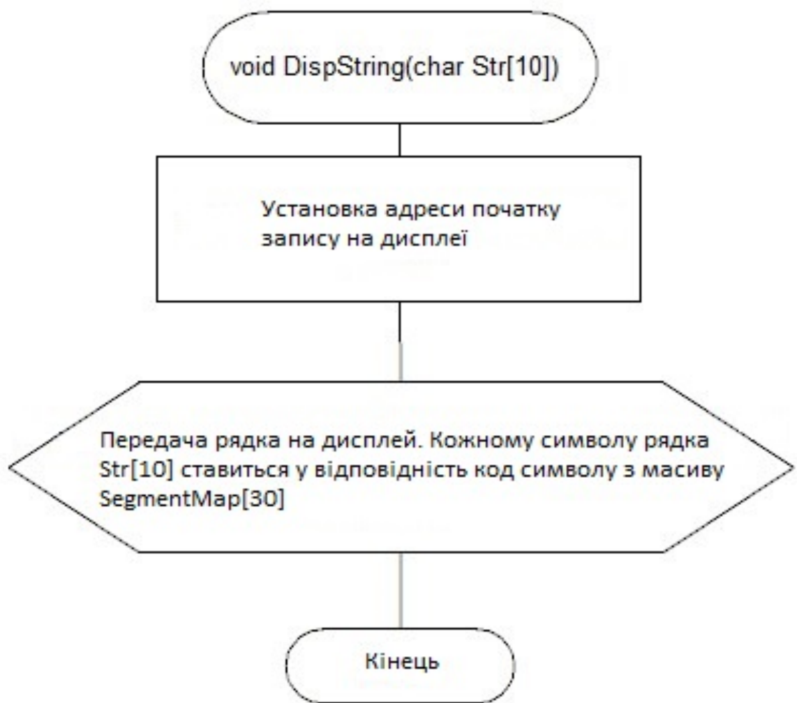
Рисунок 7.7 – Блок-схема підпрограми DispString (char Str[10])
