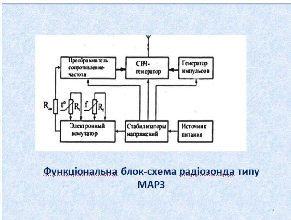
Рисунок А.3 – Функциональна блок-схема радіозонда типу MAR3
