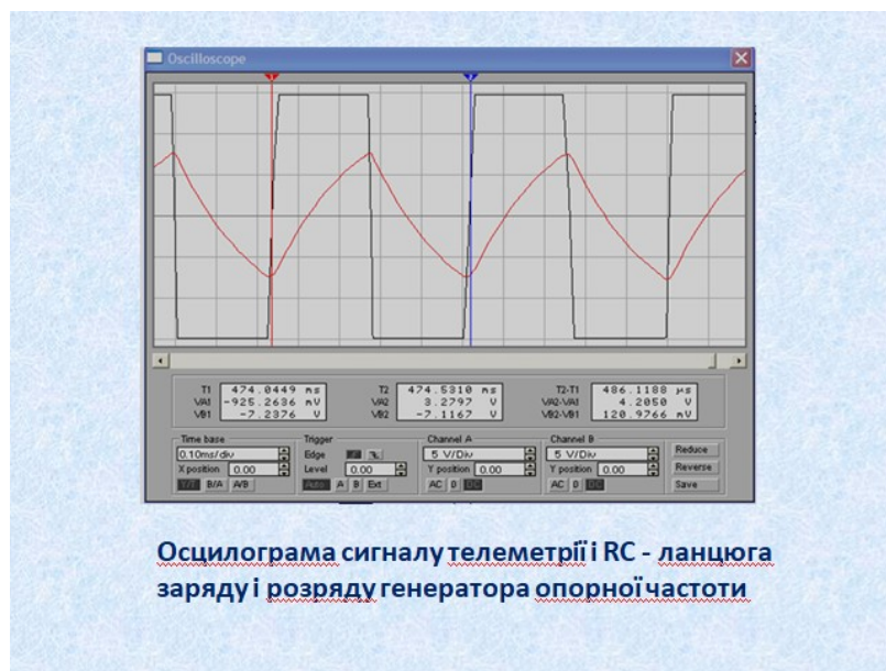
Рисунок А.8 –Оцилограма сигналу телеметрії і RC- ланцюга заряду і розряду генератора опорної частоти
