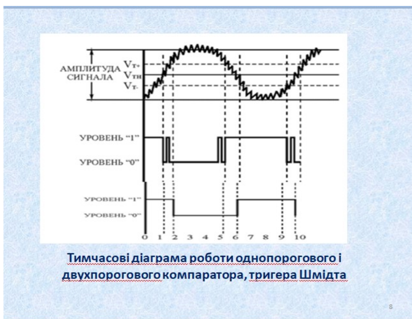
Рисунок А.7 – Тимчасові діаграма роботи онопорогового і двухпорогового компаратора тригера Шмідта
