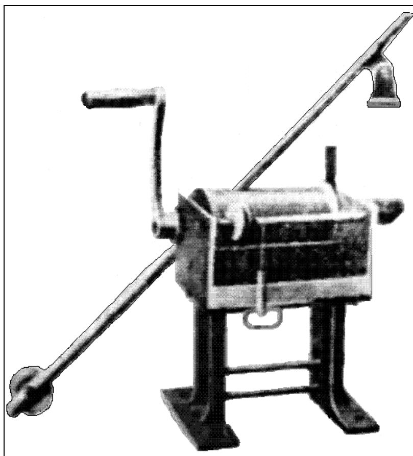
Додаток 18 – Гідрометрична лебідка (лот механічний) “Луга” (ПИ-24)
