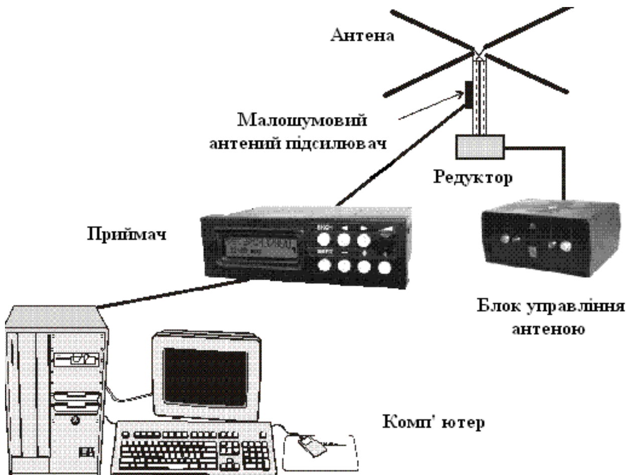
Рис. 1.13 – Склад наземного устаткування для прийому супутникового сигналу формату АРТ (існує комплектація без блоку управління антеною)
