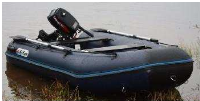
Надувний човен класу Roll Up, виготовлений з армірованого ПВХ
