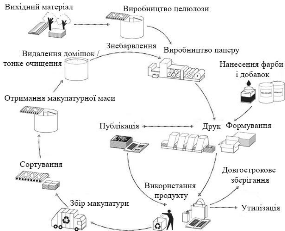
Рис. 4.2 – Процес переробки макулатури в загальному циклі виробництва і споживання паперової продукції [38]
