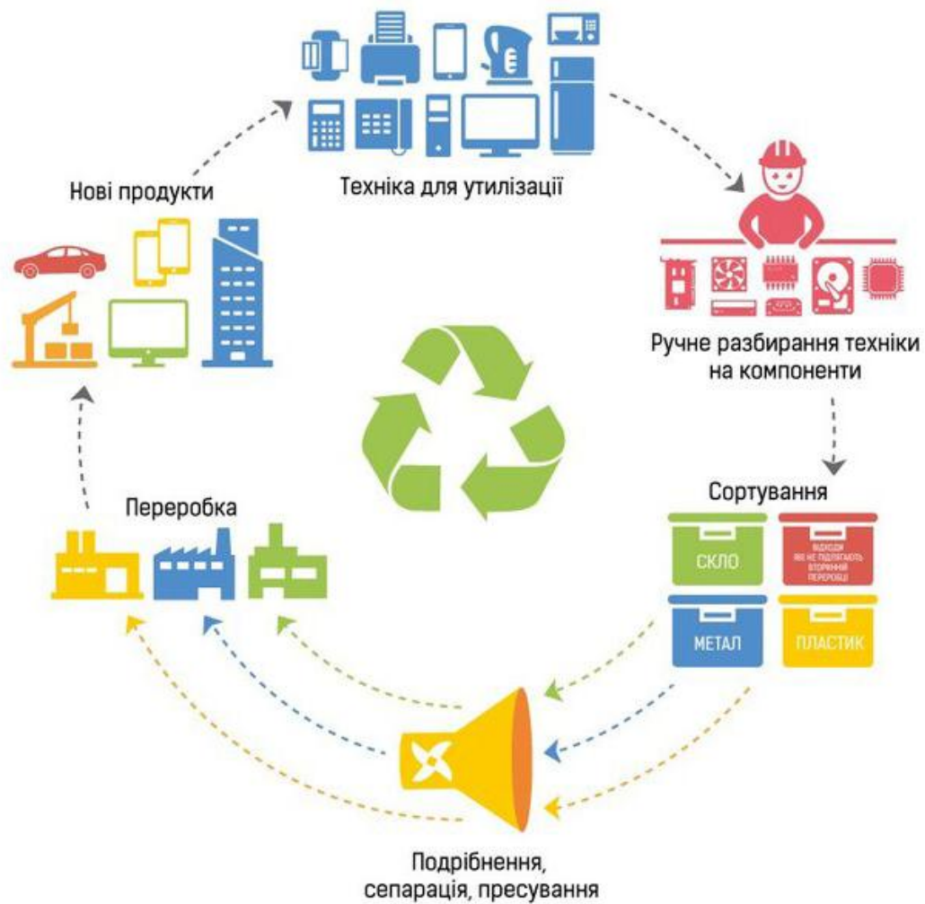
Рис. 4.1 – Процес розбору і переробки побутової техніки[40]
