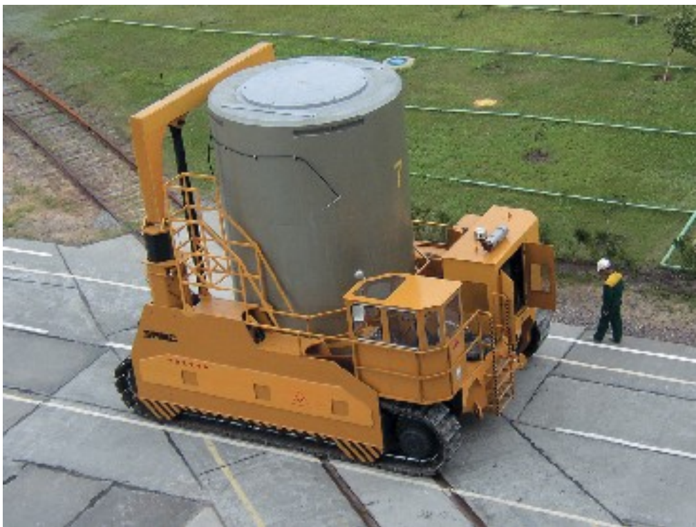
Рис.2 - Контейнери для сухого зберігання ВЯП: а – сухі сховища ВЯП Запорізької АЕС; б – доставка контейнерів з ВЯП у зону зберігання
