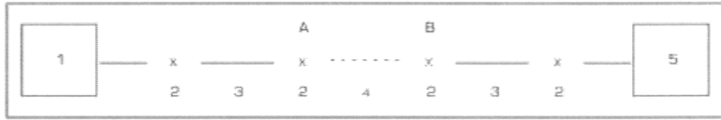
Рисунок 3.4 – Схема измерения вносимого затухания по FOTP-171
