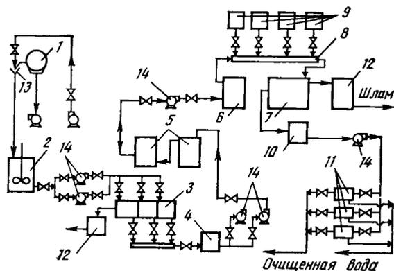
Рис. 3. Схема установки для очистки эмульсионных водных систем от масел, смол и шлама: 1 — вакуум-фильтр; 2 — мешалка; 3 — отстойник; 4 — буферная емкость; 5 — усреднители; 6 — электролизер; 7 — электрофлотатор; 8 — реактор; 9 — емкости реагентов; 10 — накопительная емкость; 11 — фильтры; 12 — сборники; 13 — лейка; 14 — насосы
