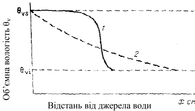
Рис. 3.4 – Два рішення рівняння дифузії для горизонтального потоку [рівняння (3.9)] при граничних умовах, заданих у прикладі 3.8. У першому рішенні (крива 1) дифузність води розглядається як функція вологості. Це рішення показує лінію промочування, а розподіл вологи нагадує результати дослідів на знаходження фактичної інфільтрації. У другому рішенні (крива 2) передбачається постійна дифузність води. Це рішення показує відсутність лінії промочування, а розподіл відрізняється від спостережуваного під час дослідів на визначення інфільтрації.
