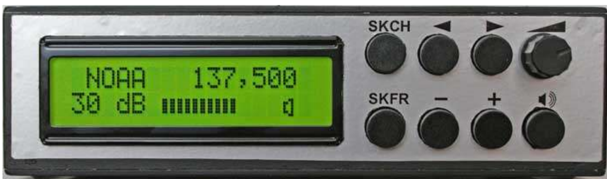
Рис. 3.12 – Вигляд передньої панелі приймача
