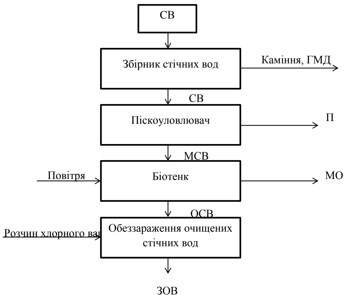
Рис. 3.3 – Принципова схема матеріального потоку очищення стічних вод.
