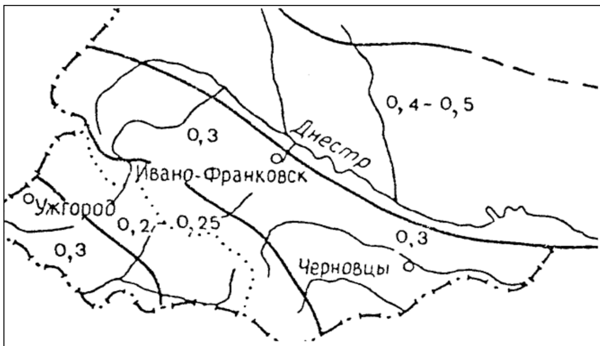
Рисунок 2.7 – Схематична карта районів гідрогеологічного параметру a_T в формулі (2.37)
