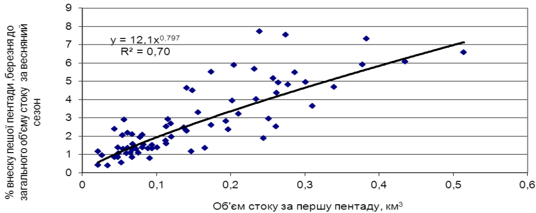
Рис.4 – Залежність між об'ємом стоку за першу пентаду березня та відсотком внеску даної пентади у загальний об'єм стоку за весняний сезон р. Прип'ять – м. Мозир, 1936-2009 рр.
