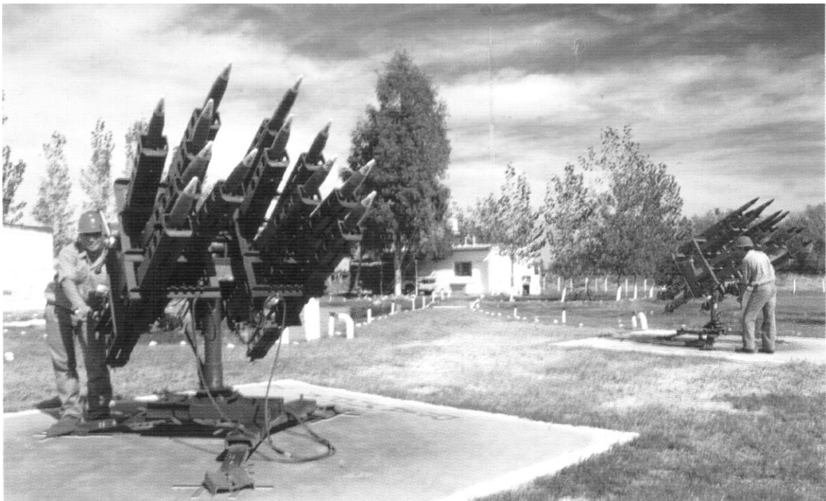
Рисунок 2.6 – Направляючі комплексу пускової установки
